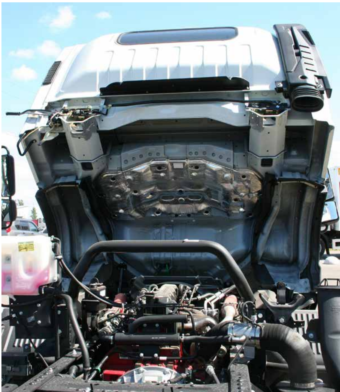
При поднятой кабине 3,8-литровый дизельный двигатель Cummins буквально как на ладони
